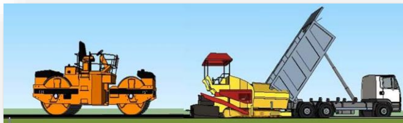
รูปที่ 2.8 การบดทับชั้นผิวทางพาราแอสฟัลต์คอนกรีต
